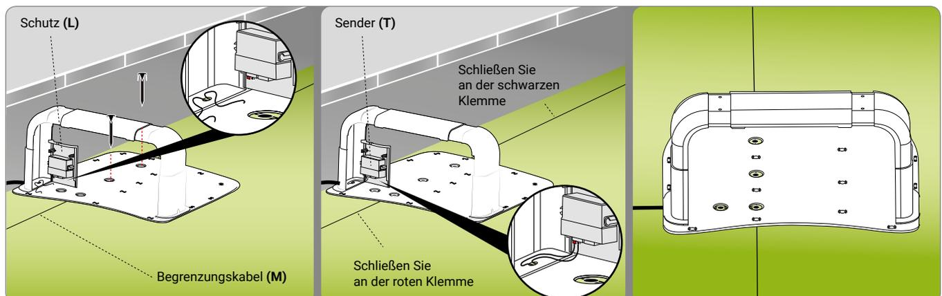
5. Fixieren Sie die Ladestation (N) am Boden mit den Nägeln (P). Falls erforderlich können sie die Ladestation mit Spreizdübeln (Q) befestigen.
