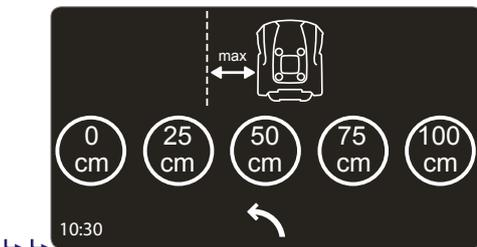
“0 cm”. Empfohlene Einstellung in komplexen Gärten mit vielen Hindernissen in Nähe des Umzäunungsdrahtes und mit engen Durchgängen. Der Roboter positioniert das linke Vorderrad neben dem Umzäunungskabel, um zur Ladestation zurückzukehren.
