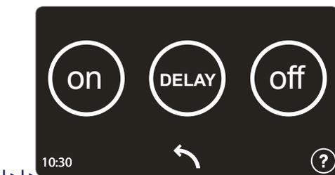
**ON:** Bei Erkennung von Regen kehrt der Roboter zur Ladestation zurück. Sobald der Ladezyklus beendet ist, nimmt der Roboter automatisch den normalen Betrieb wieder auf, falls der Sensor keinen Regen erkennt.
