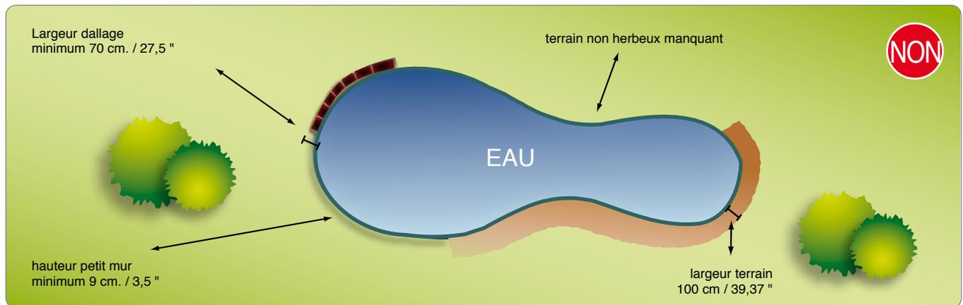
La figure ci-dessus représente une zone de travail où les zones opérationnelles du robot n'ont pas été correctement délimitées pour que le robot marche correctement.
