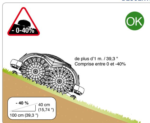
Le robot est en mesure d'affronter des différences de niveau jusqu'à 40% Pourvu qu'elles dégradent dans une distance supérieure au mètre.
