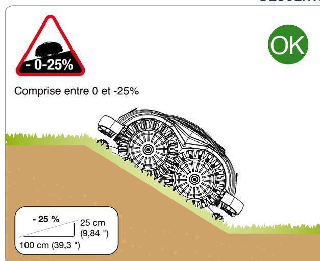
Le robot est en mesure d'affronter des différences de niveau allant jusqu'à 25% même si elles se manifestent de manière soudaine.
