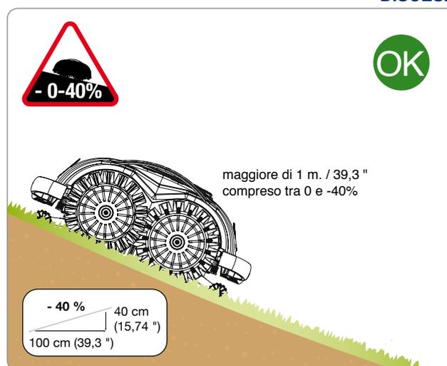
Il robot è in grado di affrontare dislivelli con inclinazione sino a 40% purché degradino in una distanza superiore al metro.
